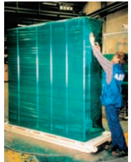
ZERUST® Valeno kiristekalvoon pakattu sähkökaappi.
